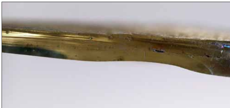
Fig. 7. Sección de un vidrio de ventana de Guadix en la que se pueden apreciar una serie de capas y oclusiones gaseosas. Foto: Isabel Cambil Campaña.
